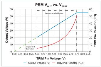
Figure 26 — PRM V<sub>OUT</sub> vs. V<sub>TRIM</sub>
