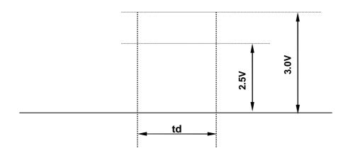
1)2.5 $V \le Vcc < 3.0V$ td  $\le 20 \text{ ms}$ 2)Vcc < 2.5V
