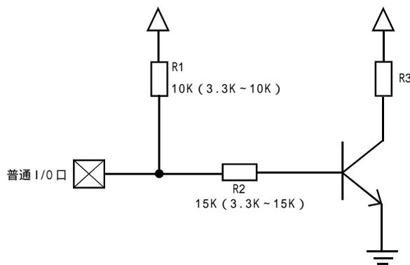
如果用弱上拉控制，建议加上拉电阻 R1 (3.3K ~ 10K)，如果不加上拉电阻 R1 (3.3K ~ 10K)，建议 R2 的值在 15K 以上，或用强推挽输出
