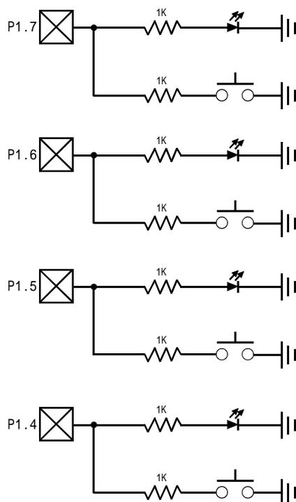
利用 STC12C5410 系列单片机的 I/O 口可设置成弱上拉, 强上拉(推挽)输出, 仅为输入(高阻), 开漏四种模式的特性, 可以利用 STC12C5410 系列单片机的 I/O 口同时作为发光二极管驱动及按键检测用, 可以大幅节省 I/O 口。
