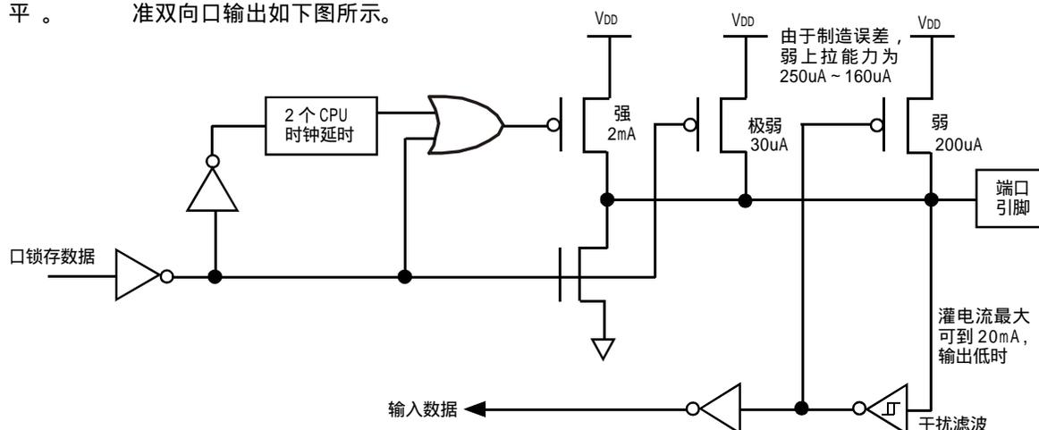
STC12LE5410 系列单片机为 3V 器件，如果用户在引脚加上 5V 电压，将会有电流从引脚流向 VDD，这样导致额外的功率消耗。因此，建议不要在准双向口模式中向 3V 单片机引脚施加 5V 电压，如使用的话，要加限流电阻，或用二极管做输入隔离，或用三极管做输出隔离。
