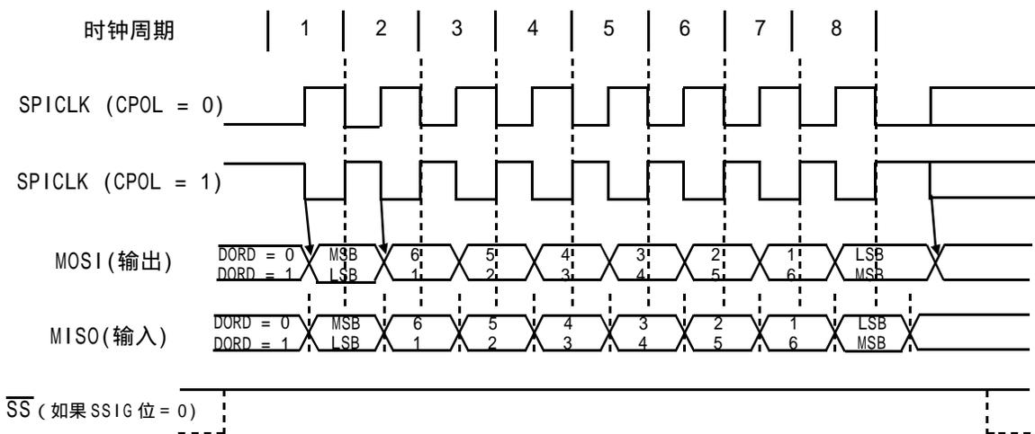
SPI 图7 SPI 主机传输格式 (CPHA=1)
