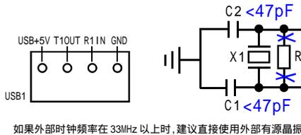
如果外部时钟频率在 33MHz 以上时, 建议直接使用外部有源晶振
