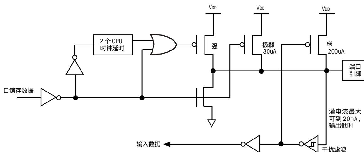
STC89LE51RC/RD+ 系列单片机为 3V 器件，如果用户在引脚加上 5V 电压，将会有电流从引脚流向 VDD，这样导致额外的功率消耗。因此，建议不要在准双向口模式中向 3V 单片机引脚施加 5V 电压，如使用的话，要加限流电阻，或用二极管做输入隔离，或用三极管做输出隔离。
