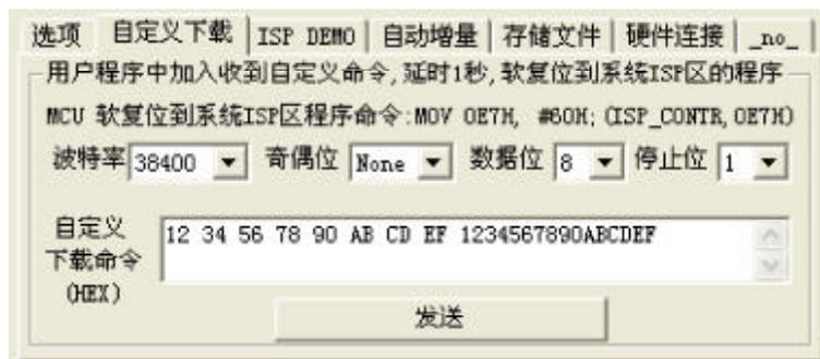
2. 需向用户程序发送的命令用户可在上图自定义下载命令输入窗口中输入(HEX)
