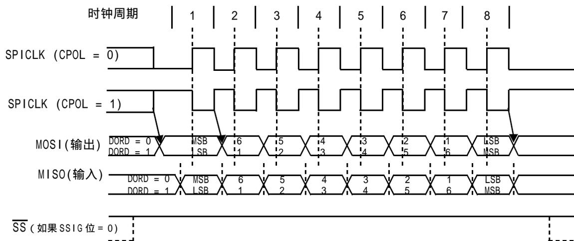
SPI 图6 SPI 主机传输格式 (CPHA=0)
