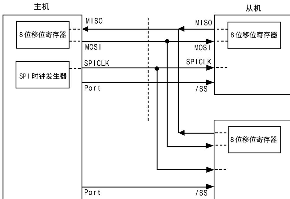
SPI 图3 SPI 单主机 - 多从机 配置
