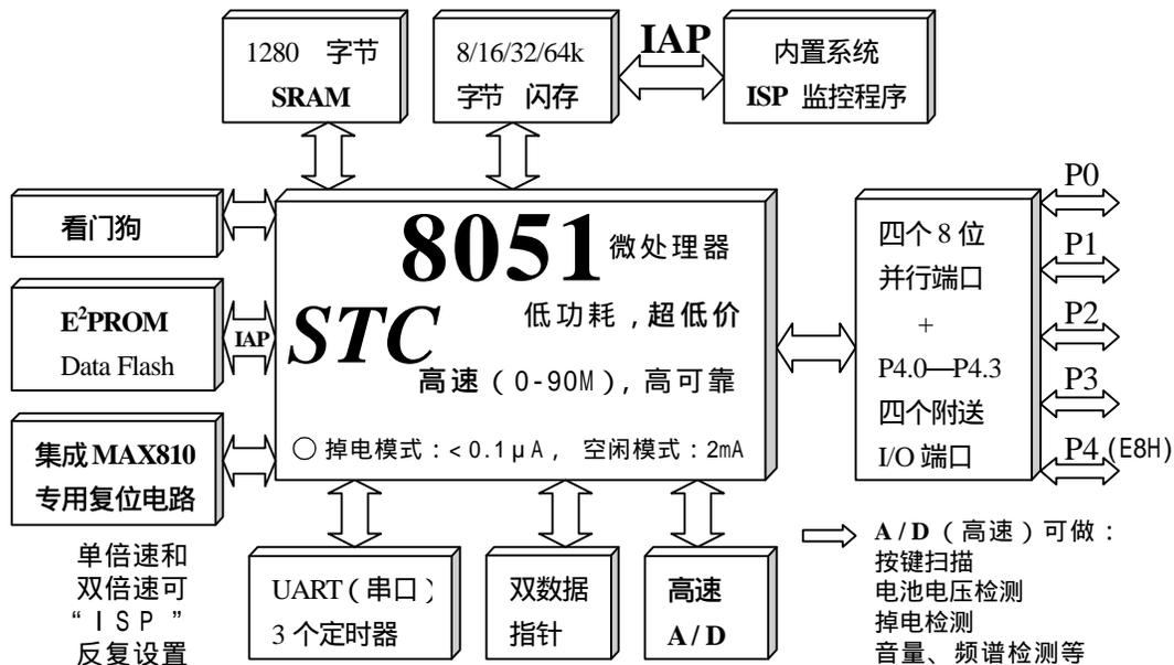
RC/RD+ 系列为真正的看门狗，缺省为关闭（冷启动），启动后无法关闭，可放心省去外部看门狗。内部Flash擦写次数为100,000次以上，STC89C51RC/RD+ 系列单片机出厂时就已完全加密，无法解密。用户程序是用ISP/IAP机制写入，一边校验一边写，无读出命令，彻底无法解密。DIP-40，PLCC-44，PQFP-44 三种封装。
