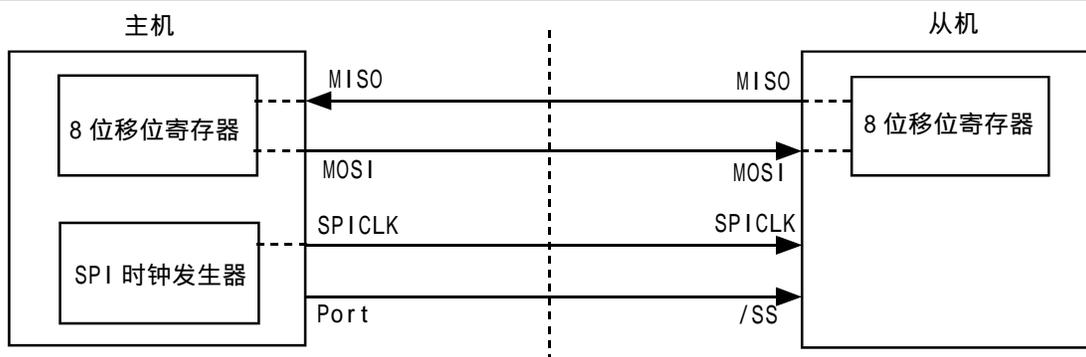
SPI 图1 SPI 单主机 - 单从机 配置
