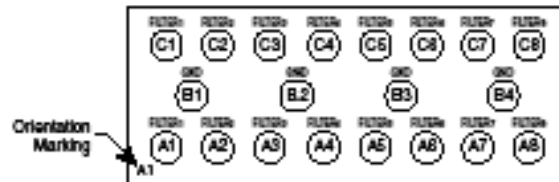
CM1451-08CS/CP 20-Bump CSP Package
