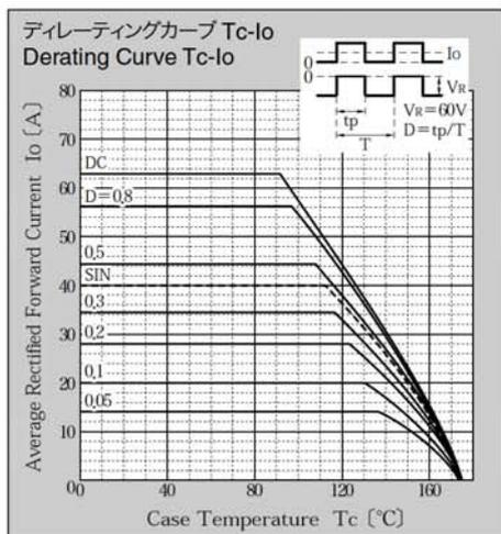
\* Sine waveは50Hzで測定しています。
