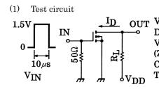
$(2) V_{IN}$   $V_{DD}=1.5V V_{GS}$   $D.U. \leq 1\%$   $V_{IN}: t_r, t_f < 5ns$   $(Z_{out}=50\Omega)$   $COMMON SOURCE (3) V_{OU}$   $V_{DS}$
